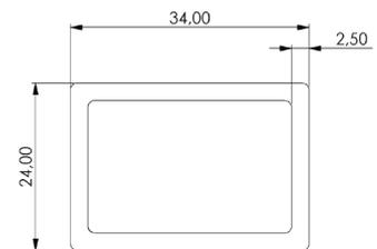
Das 40x40 mm UK-Profil wird in 2.200 mm Länge geliefert und ermöglicht einen UK- Abstand von bis zu 800 mm. Für maximale Flexibilität sorgt der 200 mm lange Schienenverbinder (34 x 24 mm), der werkseitig bis zur Hälfte in das UK-Profil (beim Set für die Systemdiele) eingesetzt wird.
