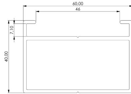
Das Standard UK-Profil für die Flexdiele wird in 3.900 / 4.000 mm Länge geliefert und ermöglicht einen Unterkonstruktions Abstand von bis zu 800 mm. Das spart Material und reduziert den Montageaufwand.
